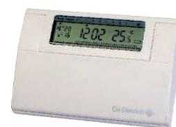
Les thermostats d'ambiance programmables assurent la régulation et la programmation hebdomadaire du chauffage par action sur le brûleur selon différents modes de fonctionnement : "Automatique" selon programmation, "Permanent" à une température réglée ou "Vacances". Pour une optimisation des économies, les thermostats d'ambiance peuvent être complétés par le raccordement d'une sonde extérieure.
